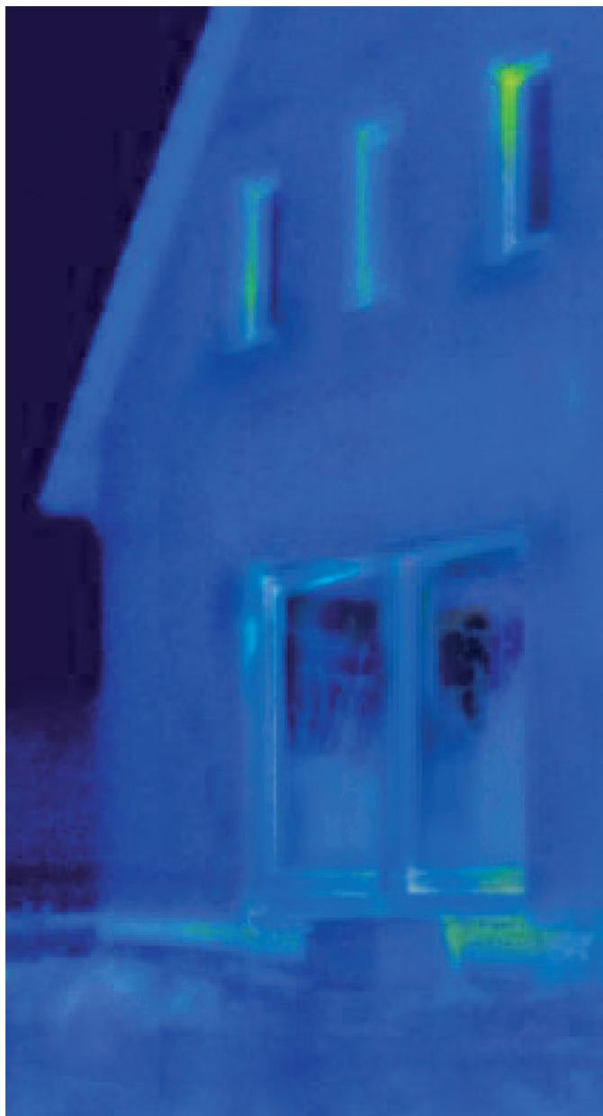
**Après rénovation :** la mise en œuvre du levant-coulissant GENE0 réduit sensiblement la déperdition thermique.
